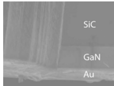
图 2 GaN 蚀刻至其下的金 (Au) 层
